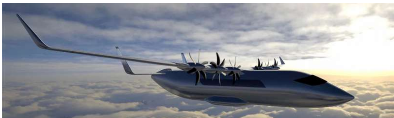
Fig. 53 - Projet d'avion électrique régional (19 places) par Aura Aéro
