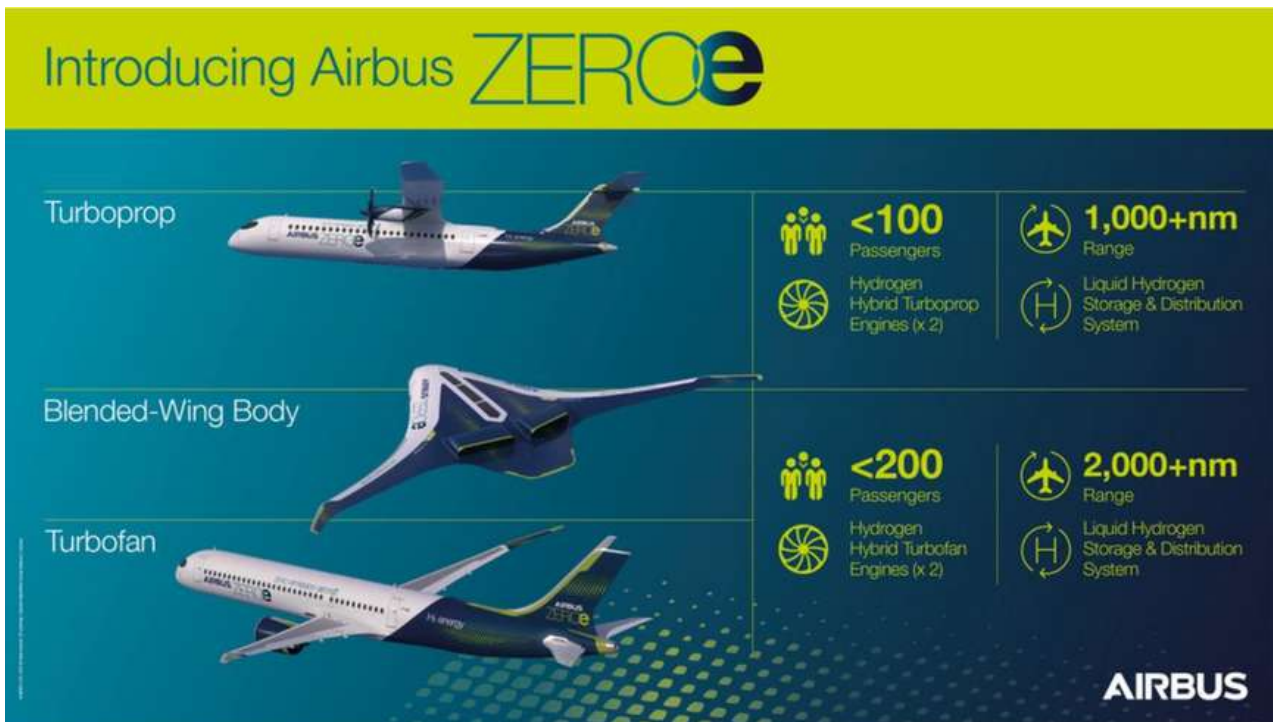
Fig. 34 - Dès 2020, Airbus indiquait une autonomie maximale de l'ordre de 2000 nm (soit environ 3700 km)
